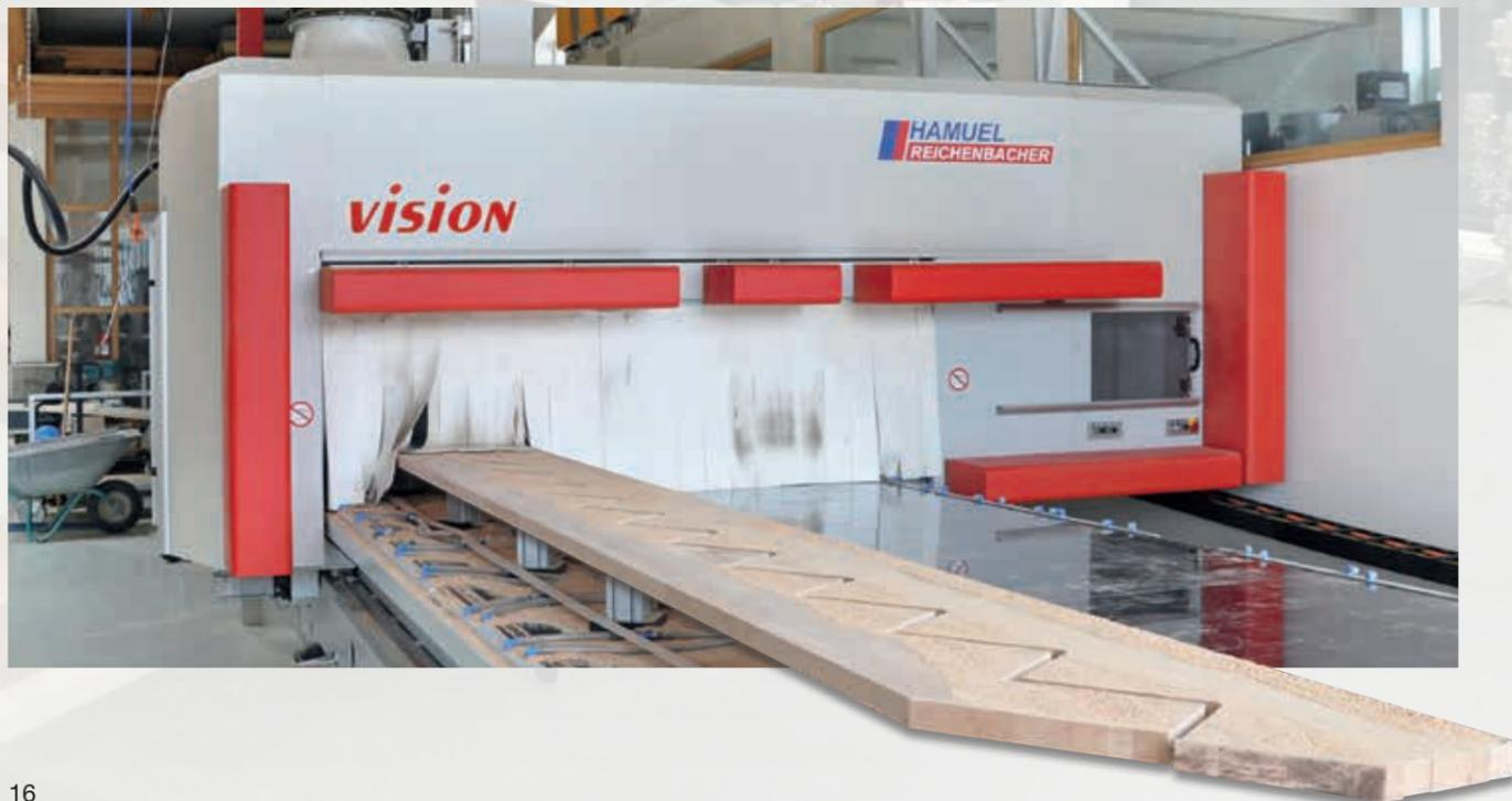
die Bearbeitungsmodi optimal umsetzt. So beweist bei hohen Bauteilen die CNC-Anlage mit einer Z-Achse von 735 mm ihre Vorzüge, bei anderen ist die Maschine mit der tiefen Tischausführung besser, und bei Elementen mit einer Vielzahl an Bohr- und Fräsvorgängen wiederum ist die Anlage mit großer Werkzeugvorhaltung prädestiniert, die Prozesse wirtschaftlich zu optimieren.
