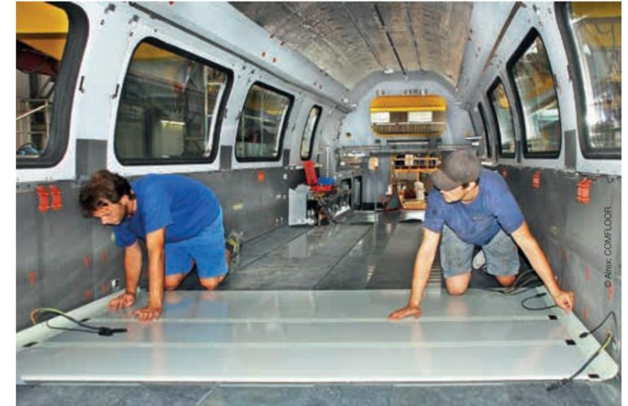
Oben: Beheizbare Bodensysteme (COMFLOOR®) für Schienenfahrzeuge werden passgenau nach Kundenwunsch entwickelt und produziert.
