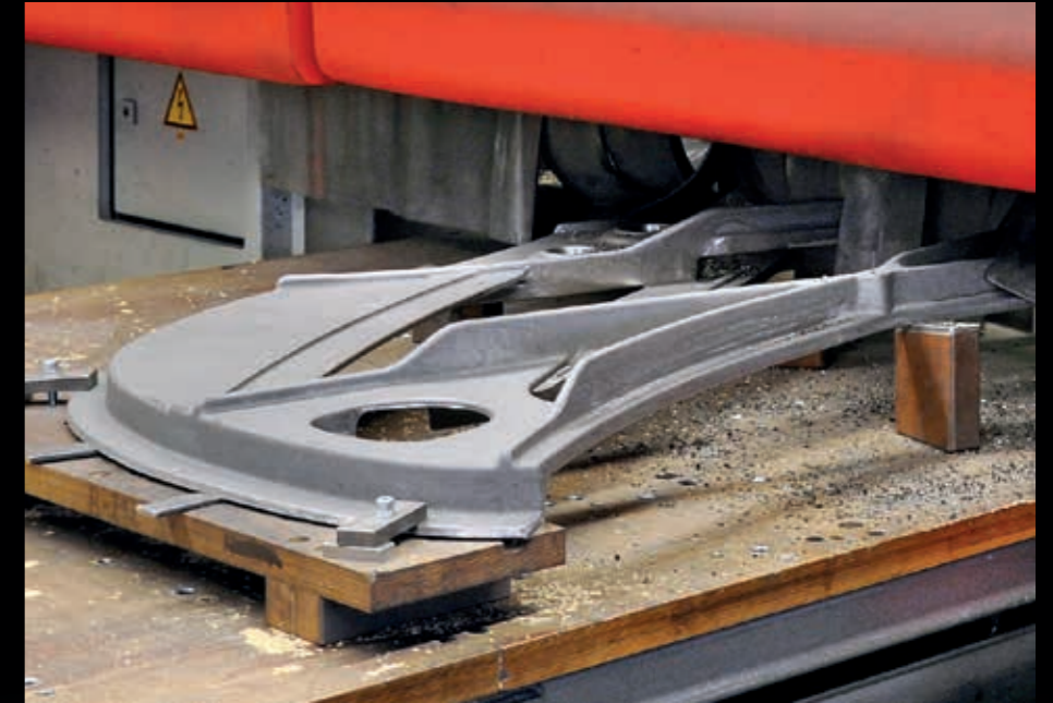
Flügelgussplatte (Material Grauguss) auf Reichenbacher VISION.
