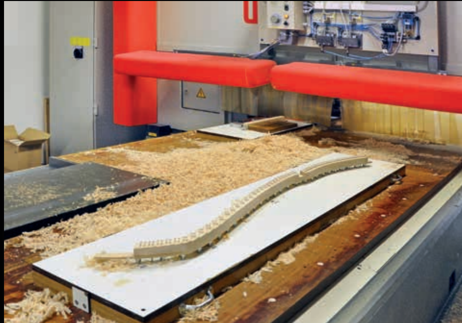
Fertig bearbeiteter Langsteg eines Klaviers (formatiert, gebohrt, Taschen gefräst und gestiftet) auf Reichenbacher UNIVERS. ersetzt.
