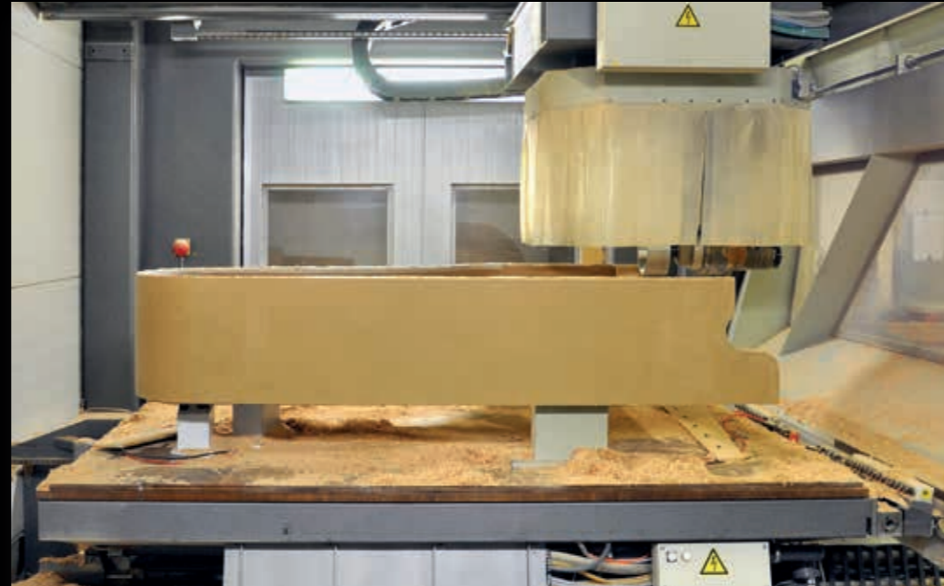
Formatierung eines Flügelkorpus auf Reichenbacher PHOENIX.
