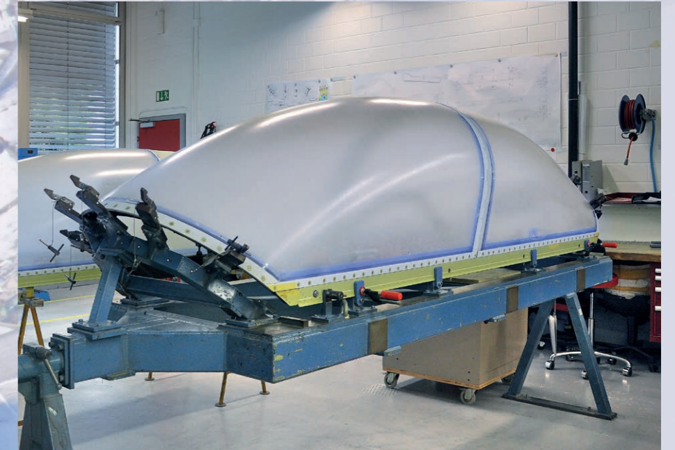
Endmontage Cockpithauben für Trainingsflugzeuge.
