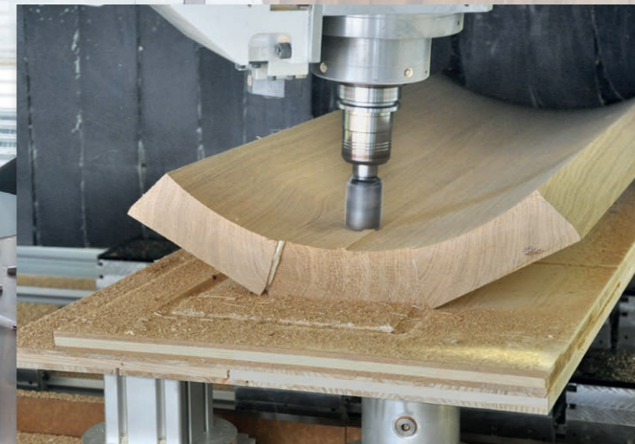
5-Achs-Bearbeitung eines Kropfpfostens.
