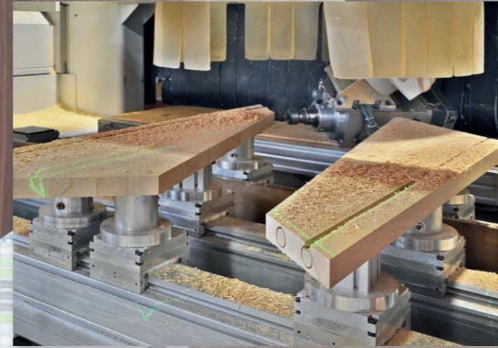
5-Achs-Aggregat mit kardanisch gelagerter 24 kW Spindel bei horizontalen Bohrungen.
