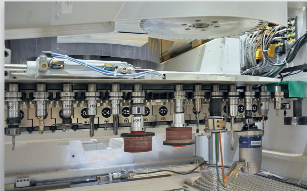
Automatischer Kettenwechsler für 40 Werkzeuge mit Pick-Up Platz für eine Säge bis max. Ø 450 mm.
