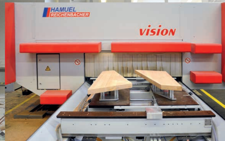
CNC-Bearbeitungszentrum VISION-II-ST Sprint mit fertig gefrästen Treppenstufen.
