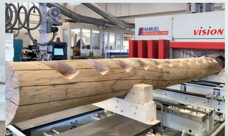
Acht Stunden dauerte die Bearbeitung des Baumstamms auf dem CNC-Bearbeitungszentrum VISION-ST-H.
