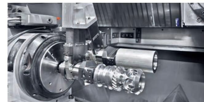
Kombiwechsler mit Doppelgreifer: Werkzeuge und Werkstücke jederzeit parat.
