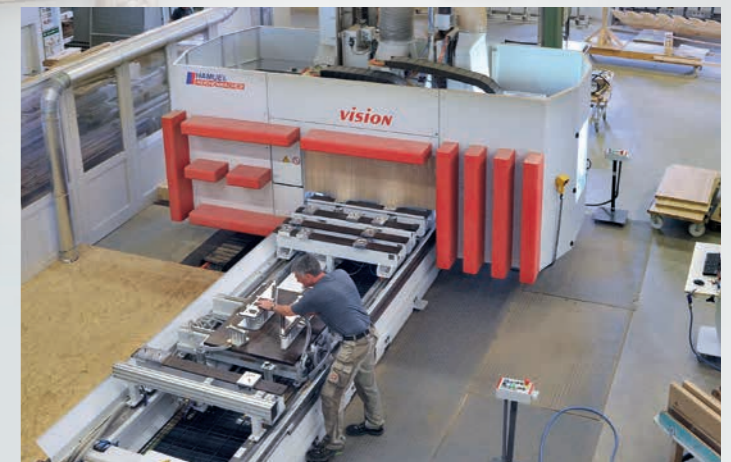
Das speziell für die Treppenfertigung konzipierte Bearbeitungszentrum mit 5-Achs-Aggregat und 3x Vertikalspindeln in der Produktion bei Meyer & Grave.
